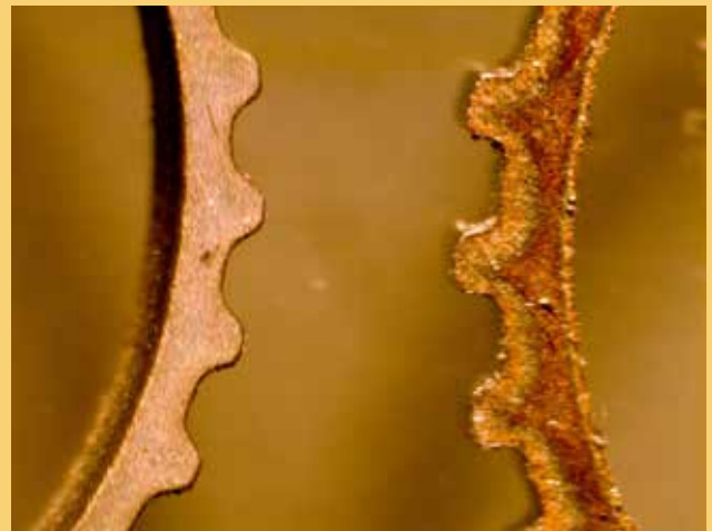
Bilden visar skillnaden på Finecuts mikroskarvningsteknik (till vänster) jämfört med traditionell laserskarvning (till höger)
